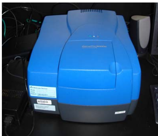
圖六、GenePix 4000B晶片掃描器，正視角度。
