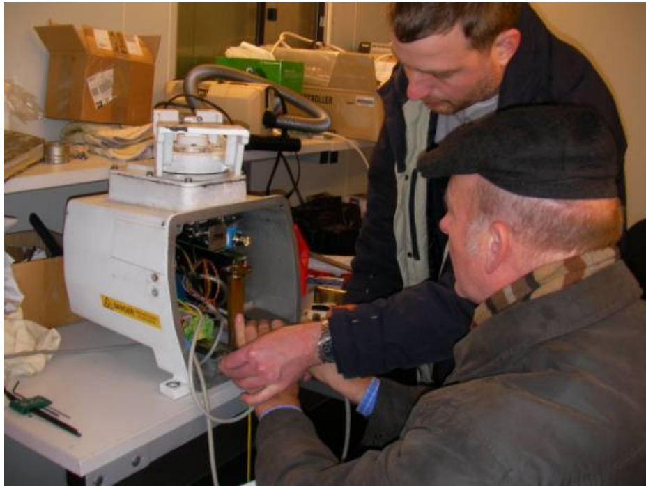
圖 53 岸基雷達之基座檢修(List 南側岸基雷達觀測站)
