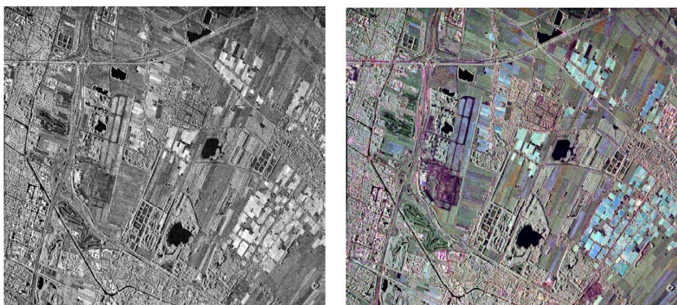
圖八：單極化及多極化之合成影像
