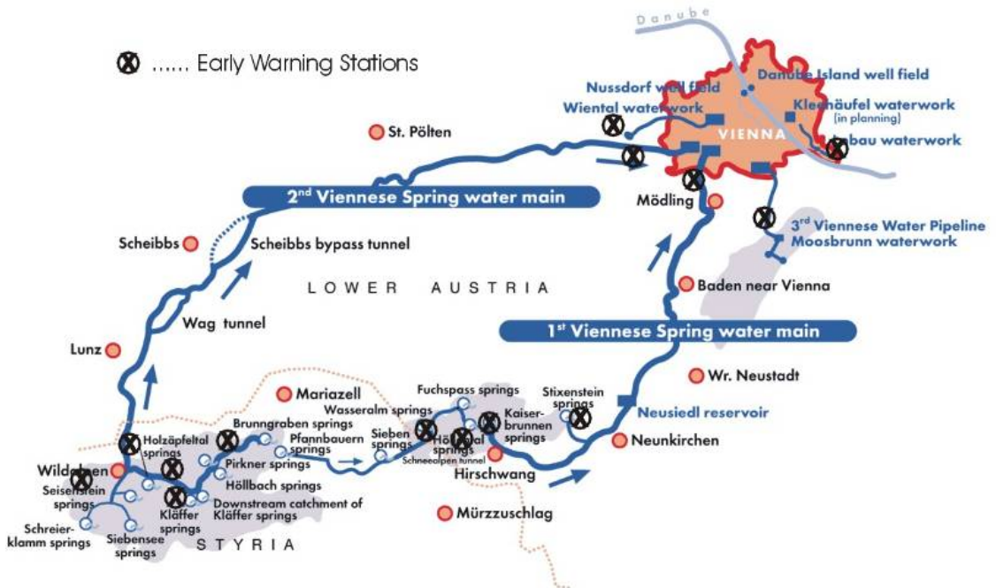
圖 15 自來水導水渠道導水渠道配置圖
