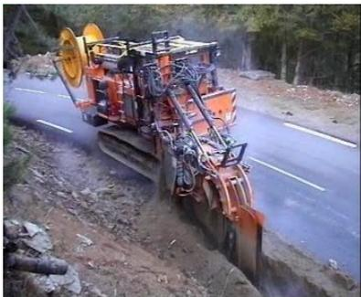
(圖 1)管溝挖掘機具
