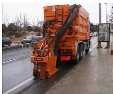
(圖 2)管溝回填機具
