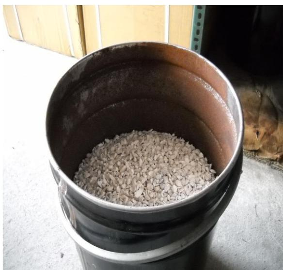
Desiccant Granules (顆粒乾燥劑)，成份是 96%的  $\text{CaSO}_4$  及 4%的  $\text{CaCl}_2$ ，Siez 是 1/8" 到 1/4" 的顆粒，以每桶 50 磅的包裝，被裝入 Shand & Jurs 94321 型 Air Dryer 來使用，每次約需 35 磅，就目前本中心的頻率而言，約每三個月需更換一次(使用量約 35 磅)。
