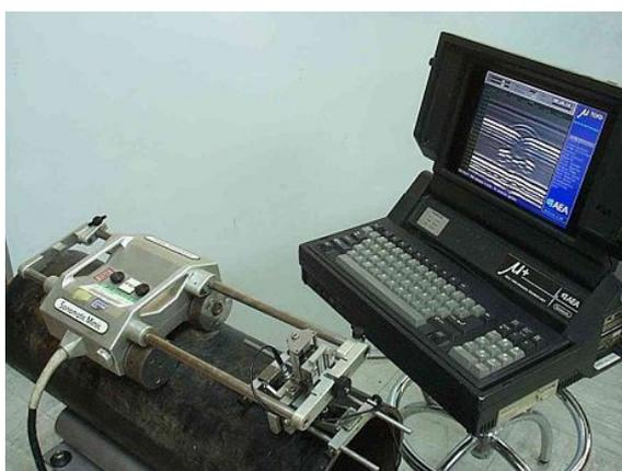
圖 12 TOFD 波形時間繞射法儀器外觀
