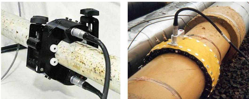
圖 24 應用於管線之導波檢測儀器
