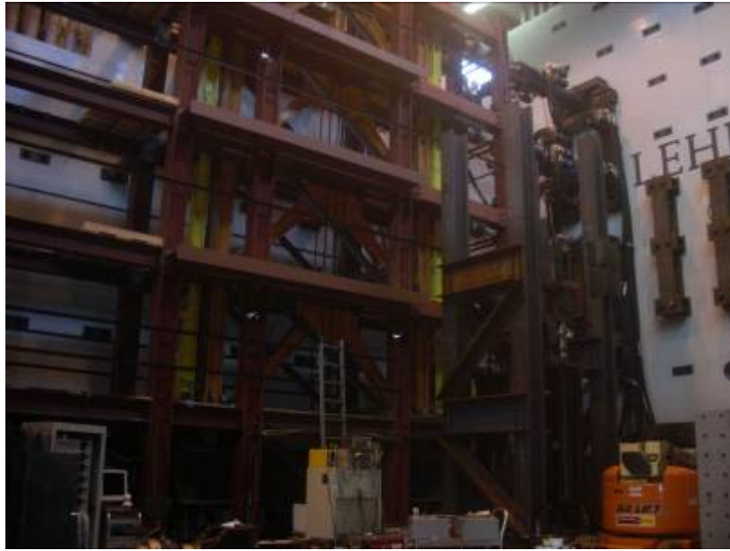
圖 4-11：實體橋樑結構動態疲勞實驗
