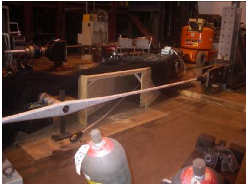
圖 4-10：複合材料拉力測試之複合材料
