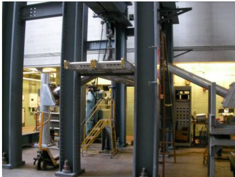
圖 4-8：鋼構塔架動態疲勞實驗
