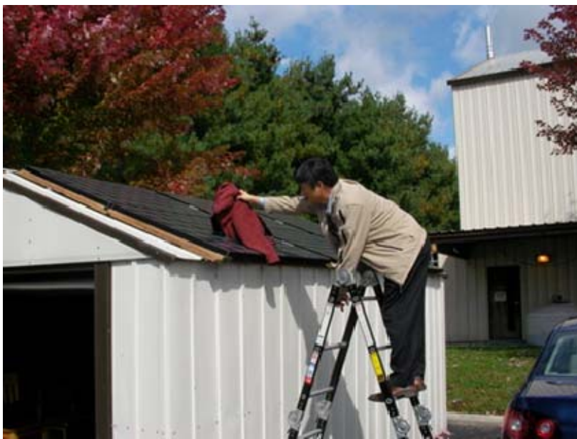
圖 2-4：Dr. Lai 親自測試 PV Inverter 之 Shedding Effect 對抗能力
