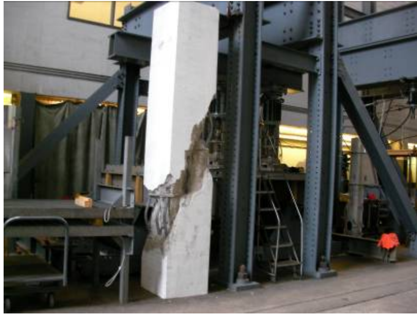
圖 4-7：結構建物之動態疲勞實驗
