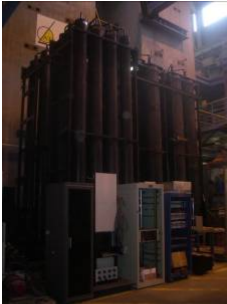
圖 4-6：瞬間推力油壓系統
