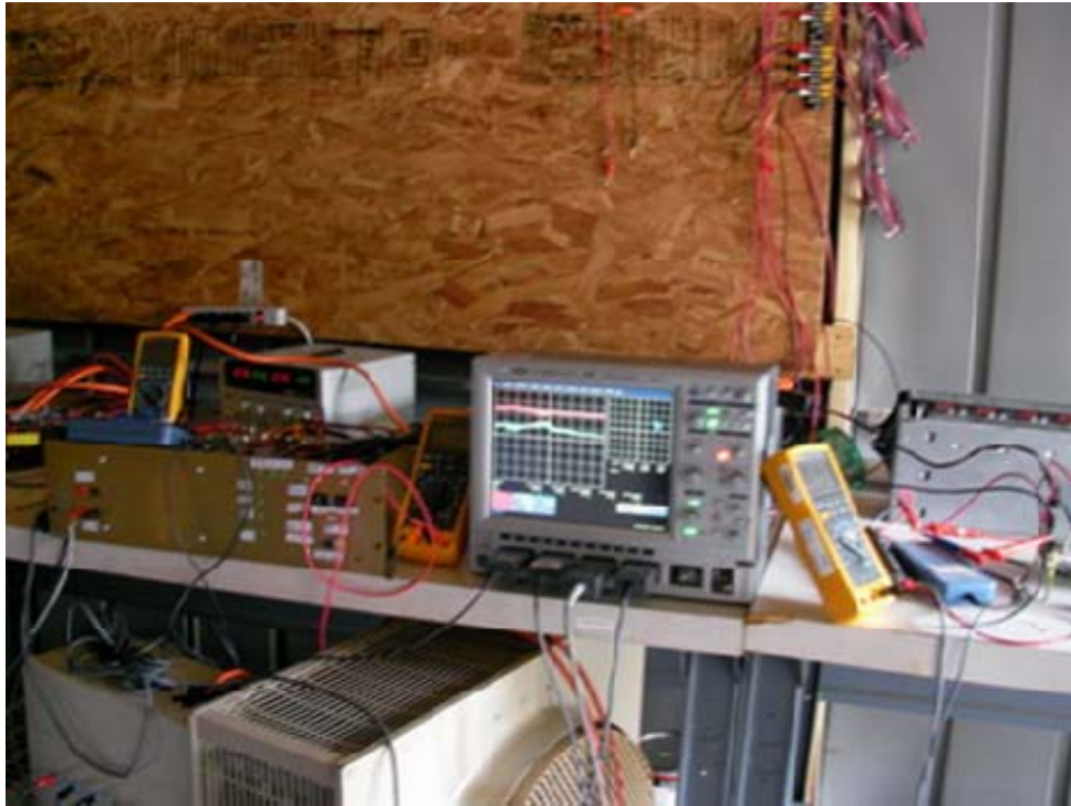
圖 3-20：示波器螢幕右圖顯示，系統控制器穩定在一點上
