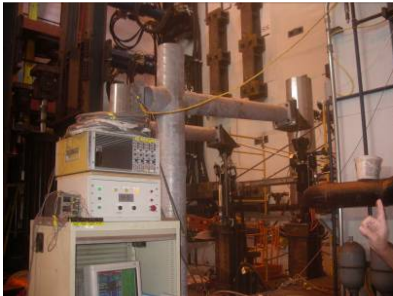
圖 4-12：40 公尺交通號誌打塔架基礎之態疲勞實驗
