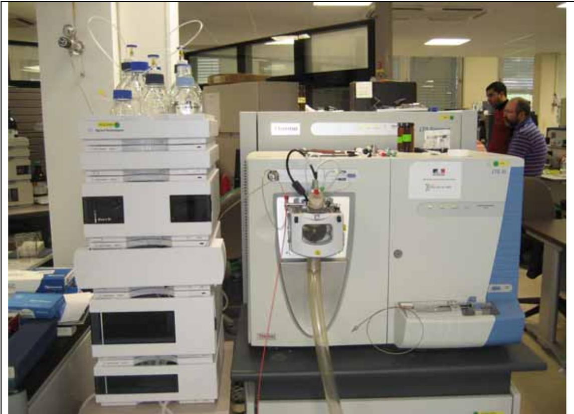
圖 6. 高解析液相層析質譜儀 (Orbital Trap)
