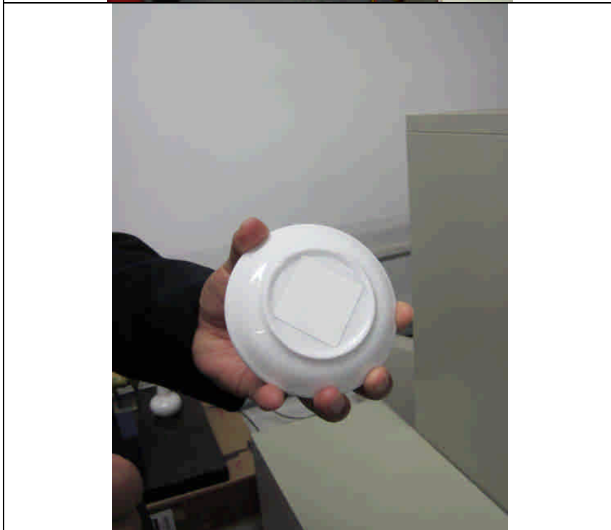
Fig.13 北京首都博物館正在嘗試文物 RFID 裝置之試驗
