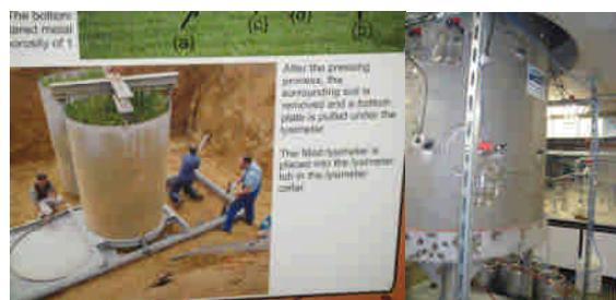
圖 2 Lysimeter 是一填滿環境土壤之圓柱體，在柱體佈置分析儀器，在可控制條件下栽培植物與施用殺蟲劑，以偵測、分析、模擬污染物在土壤之分佈、傳輸、與生化反應。
