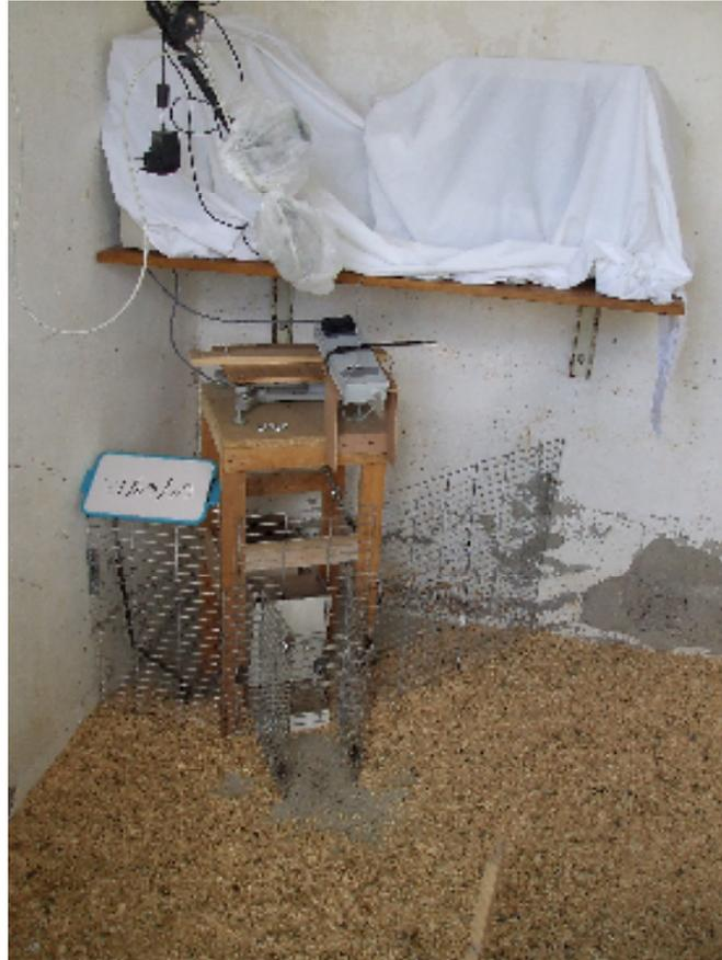
圖 25、Artiguères 研究站使用之 RFID 自動記錄採食量設備
