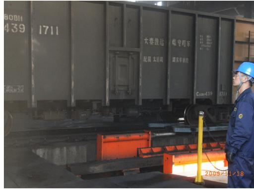
圖 17 車皮翻車系統運作情形
