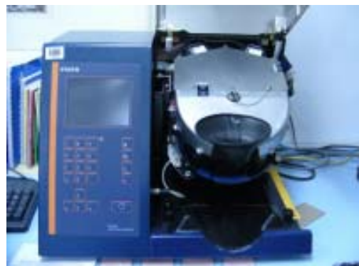
圖六、水稻米粒外觀分析儀器
