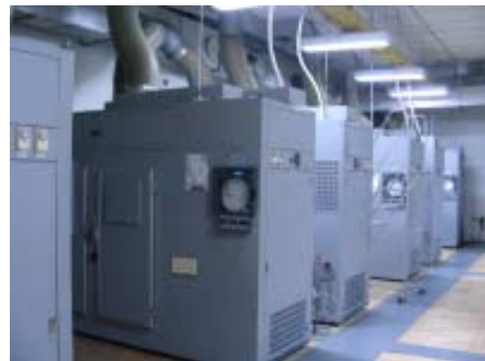
圖十八、耐熱試驗之室內人工光源室
