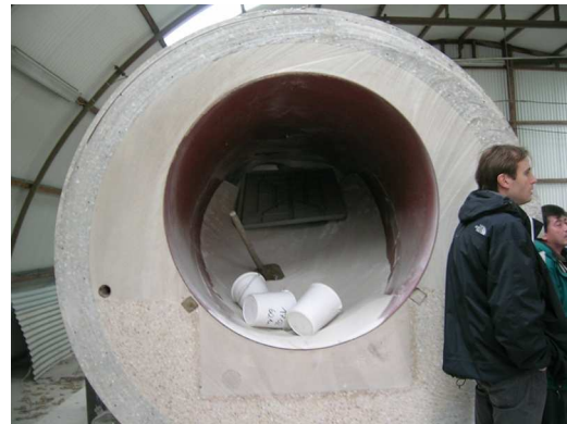
圖十一、水泥漿回填試驗：施工前（左）、完工剖面（右）
