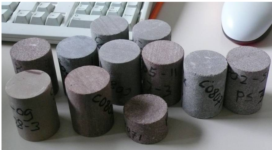
圖3.4 氣體突出實驗所使用岩心樣本，自左至右孔隙率漸增。
