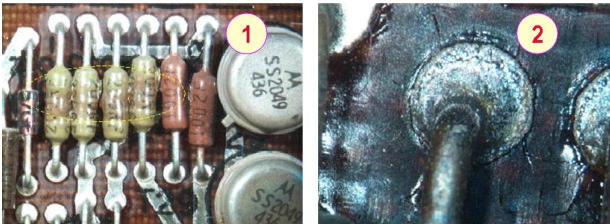
▲ 圖 13 電子電路板老化因素的案例，高溫度造成電阻過熱色碼焦黑，電路基板脆裂
