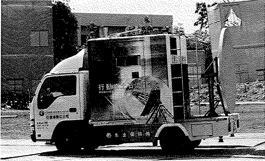
圖 7-2、行動式土石流觀測站
