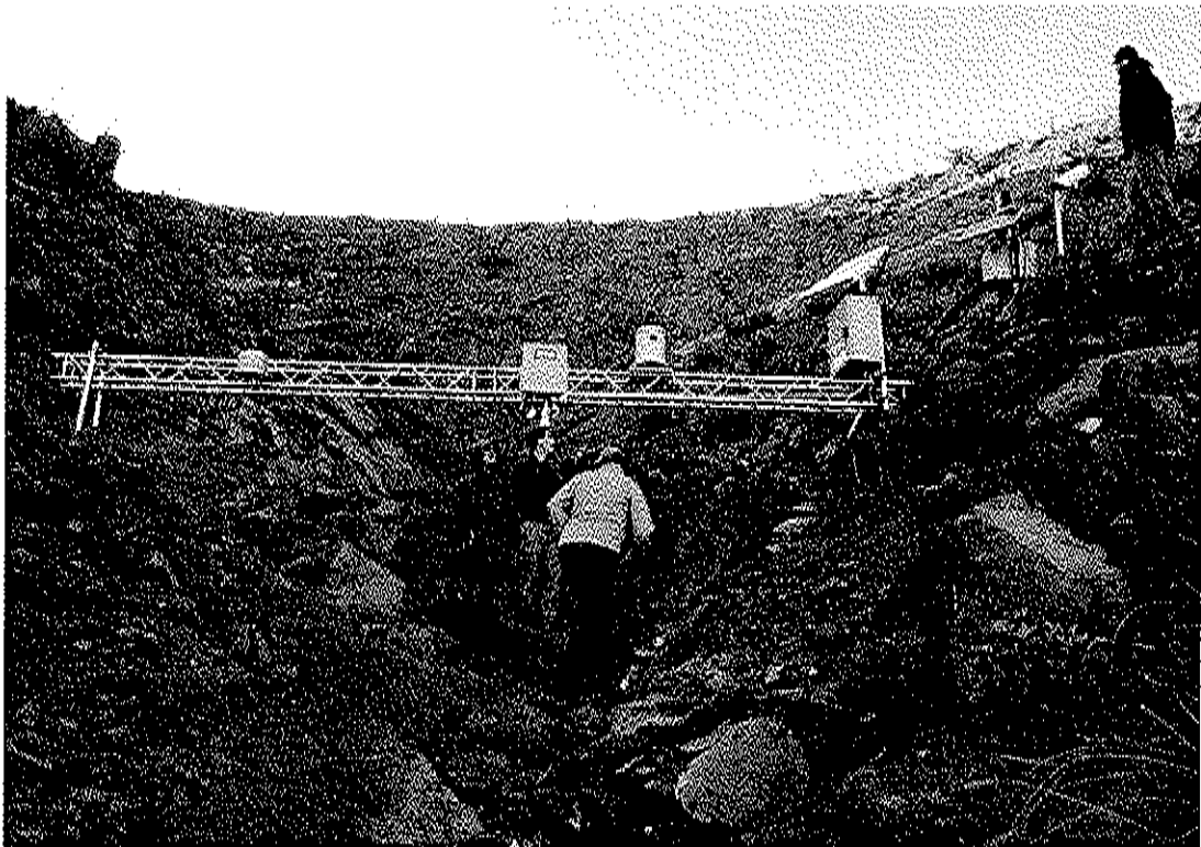
圖 6-11、主要沖蝕溝之觀測系統
