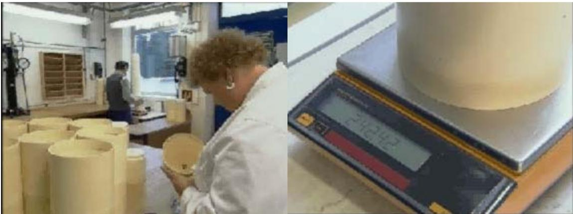
圖 40. 左圖為藥筒外觀檢驗；右圖為藥筒重量檢驗
