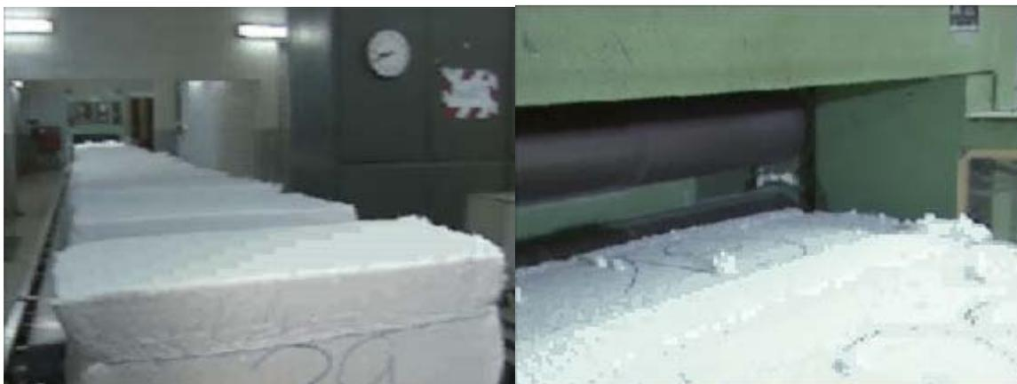
圖 25. 圖左棉花先放至輸送帶；圖右撕棉機撕棉過程
