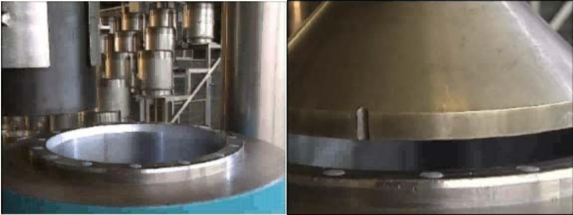
圖 17. 左圖藥塊放入篩藥機中；右圖篩藥機篩藥
