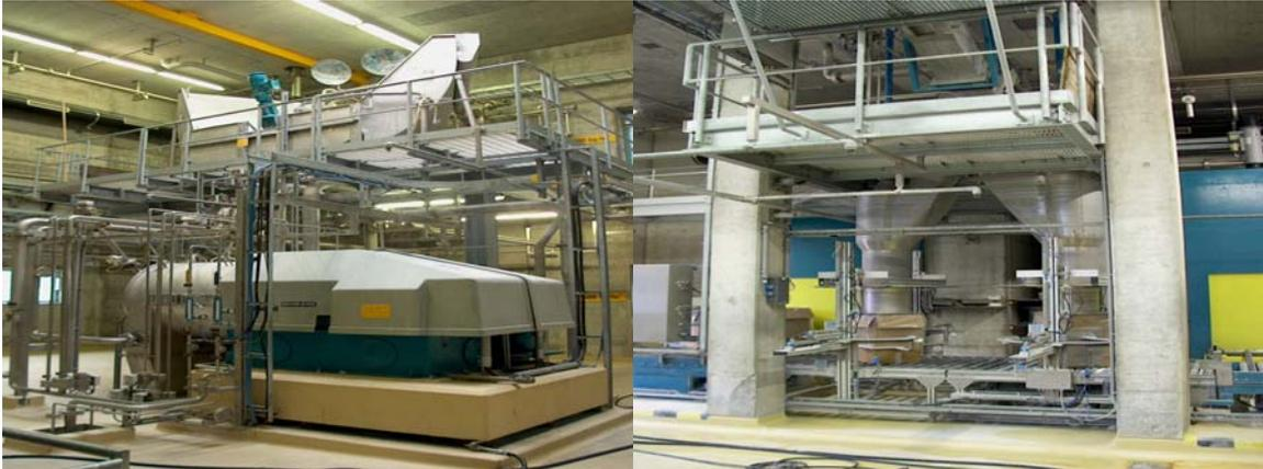
圖 32. 圖左除水機；圖右除水後硝化棉裝入紙桶中待用
