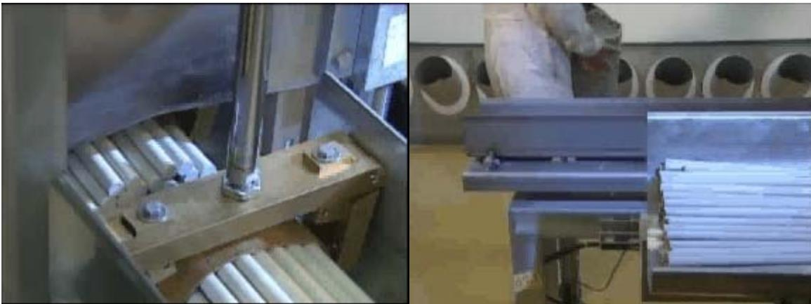
圖 33. 左圖為切藥過程；右圖切完藥條整束裝入袋中做後續處理
