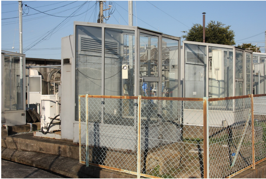
水稻高溫下米質穩定性評估試驗進行高溫處理所使用之小型溫室，僅可針對不同時間之溫度進行設定
