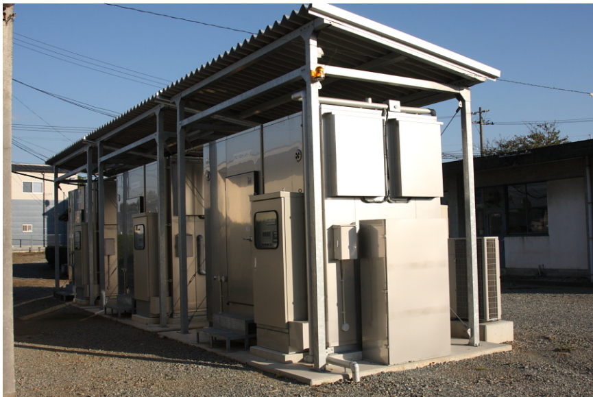
水稻高溫下米質穩定性評估試驗進行高溫處理所使用之人工氣候室，可針對不同時間之溫度、濕度、二氧化碳、光照等進行設定
