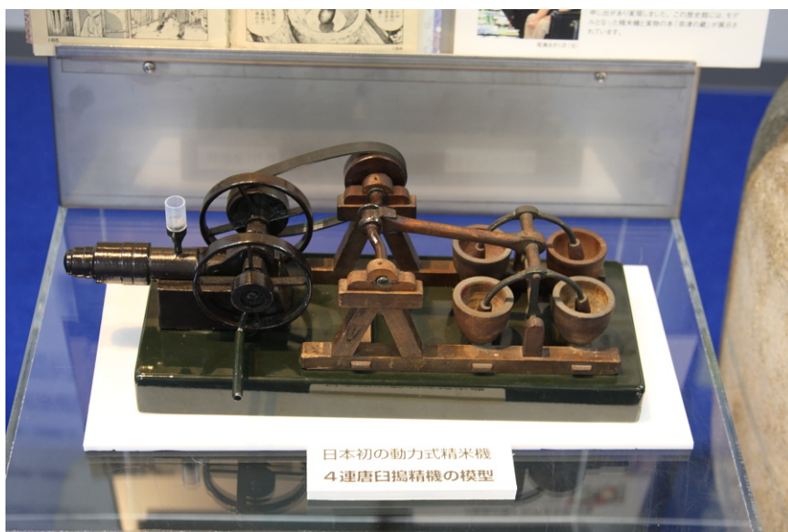
サタケ（佐竹）歴史館展示該公司所研發之日本第一台動力式精米機-4連唐臼搗精機の模型
