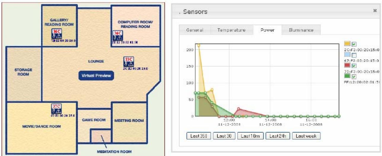
圖八：無線感測網路技術整合室內環境溫溼度監控與電子讀表示意圖
