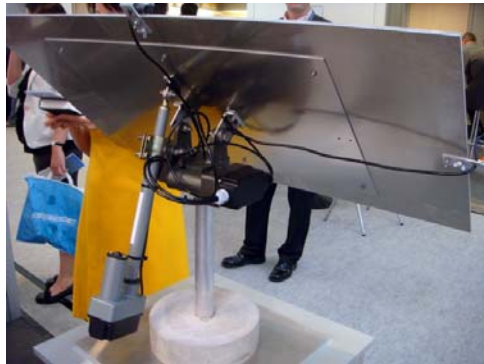
圖37 德國Degerenergie之tracker系統傳動機構
