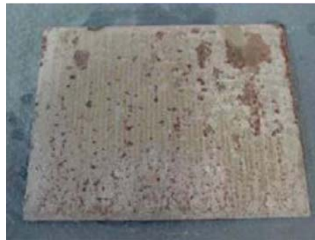
圖 53 未處理之 Al 2024 經鹽霧測試 96 小時
