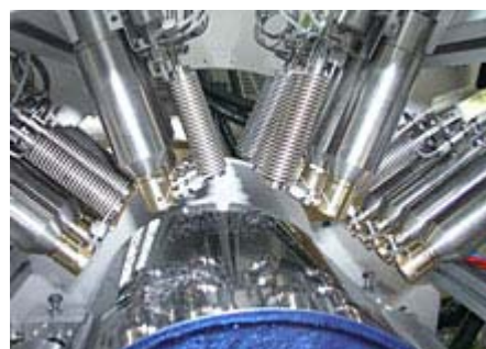
圖 49 塑膠膜活化及鍍膜製程
