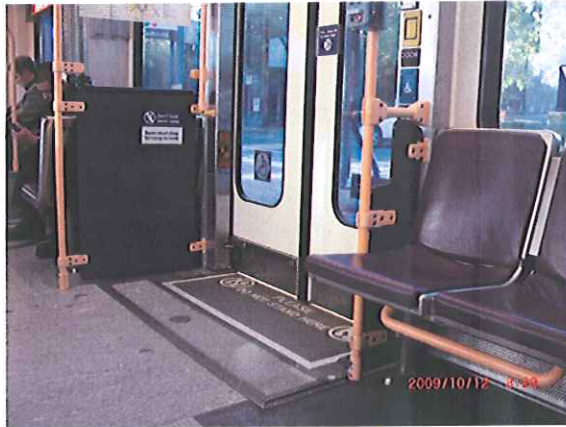
98.10.12 波特蘭市電車 TriMet (門口的平台可以延伸至月台便利上下車)
