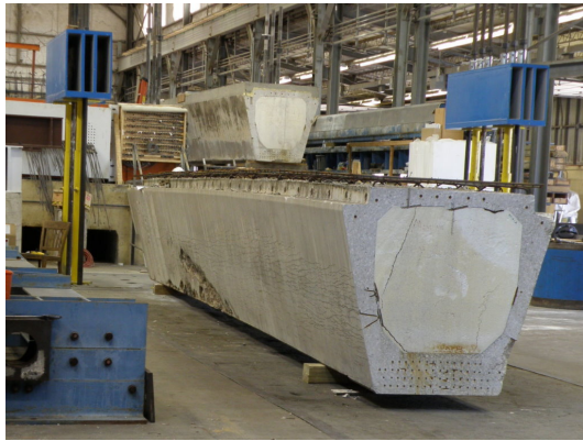
圖 6 箱型樑鋼筋腐蝕檢測實驗
