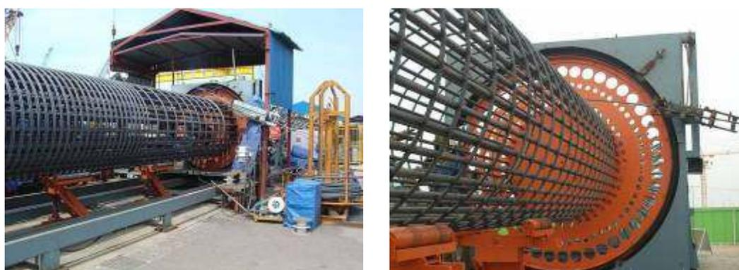
圖 2.7 鋼筋綁紮機具
