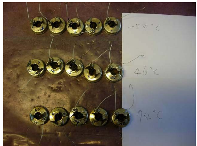
圖五、檢視功能試驗後之點火器
