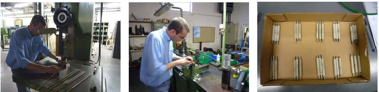
圖十四、穩定桿試桿製作
