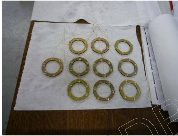
圖十九、鹽霧試驗後之隔板
