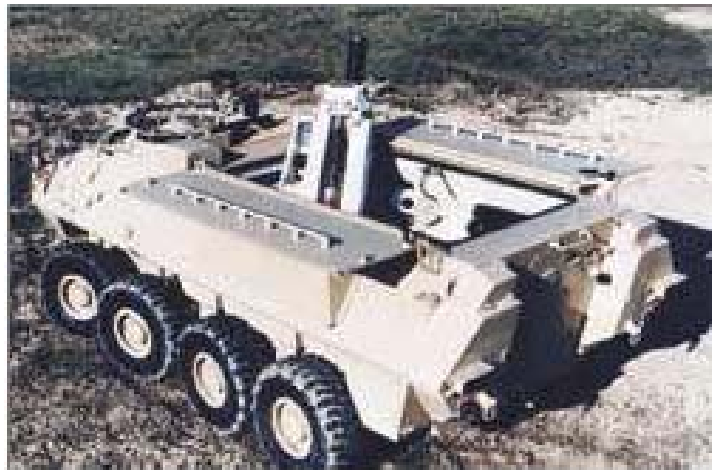
圖十四、一套 TDA 2R2M 120mm 迫擊砲系統安裝在 MOWAG Piranha 裝甲車上
