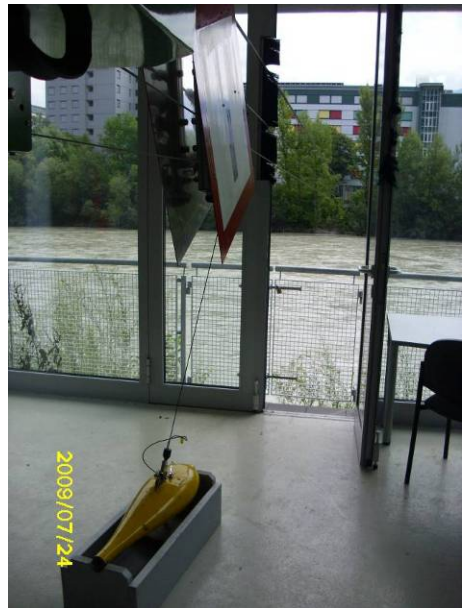
照片 56 量測懸移載鉛魚及懸掛纜車系統
