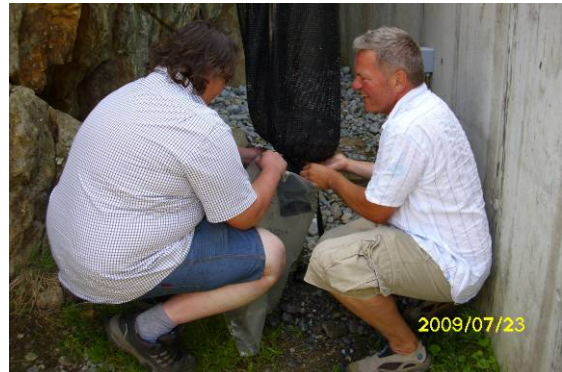
圖 27 自取樣器移出截取的推移載
