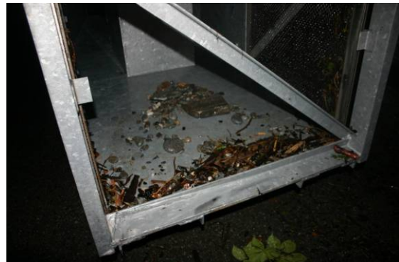
圖 32 TIWAG 推移載取樣器內部情形
