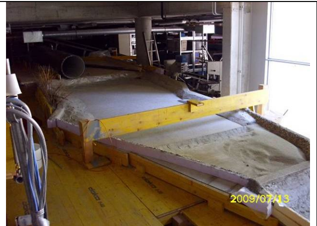
照片 02 BOKU 山區防災研究所有關泥砂運移之水工試驗(1)
