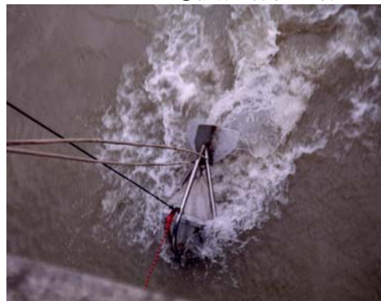
LHSS 推移載取樣器作業情形
