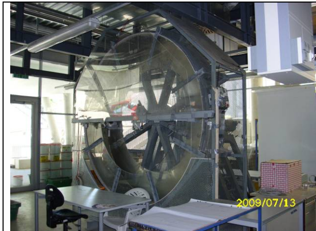
照片 03 BOKU 山區防災研究所有關泥砂運移之水工試驗(2)
