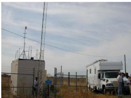
CARB 查核設備均安裝於專用查核車上，查核時僅需將查核氣體管路由查核車拉至採樣管執行 Through The Probe (TTP) 方式查核即可，不需搬移設備至測站內。測站使用之監測儀器、查核儀器、
