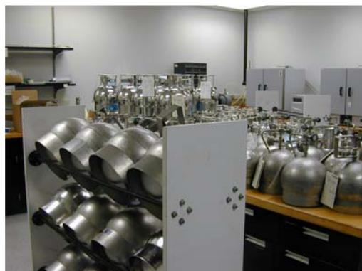
除設置 2 個 24 小時連續自動之光化學評估監測站(PAMs)，並佈設 5 個人工採樣測點，依規定定期執行採樣後，送實驗室進一步分析。依聯邦環保署訂定標準方法包括 T0-15 及 T0-17 等。由於大氣中 VOCs 成份複雜且濃度甚低，分析前必需經過濃縮聚焦的過程，以取得適量之分析濃度。考量自動監測設備設置成本及儀器分析偵測極限，目前加州多數 PAMS 測站仍以人工採樣後送回實驗室進行分析。為加強數據品保之控管，諸
