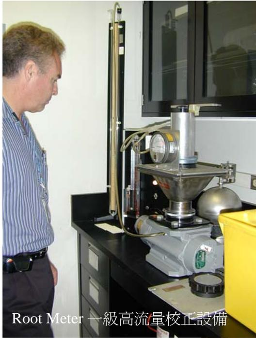
Root Meter 一級高流量校正設備
