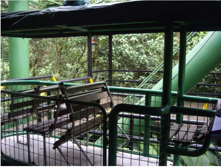
說明：(左圖) 鐵鑄纜車每台有 4 排座位，前 3 排可坐 2 人，最後一排，一般為解說人員坐位。 (右圖) 纜車基座之控制台。
