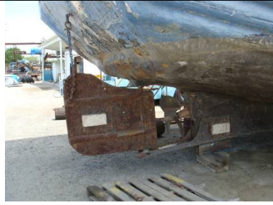
圖十四、現加裝引擎動力與螺旋槳及新船舵
