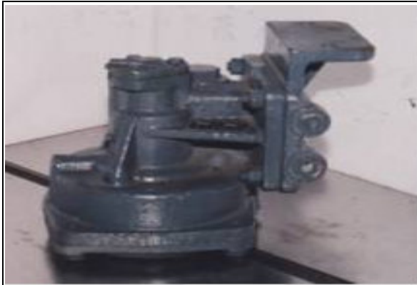
圖 43：內燃機車真空比例閥
