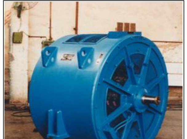
圖 22：同步主發電機
