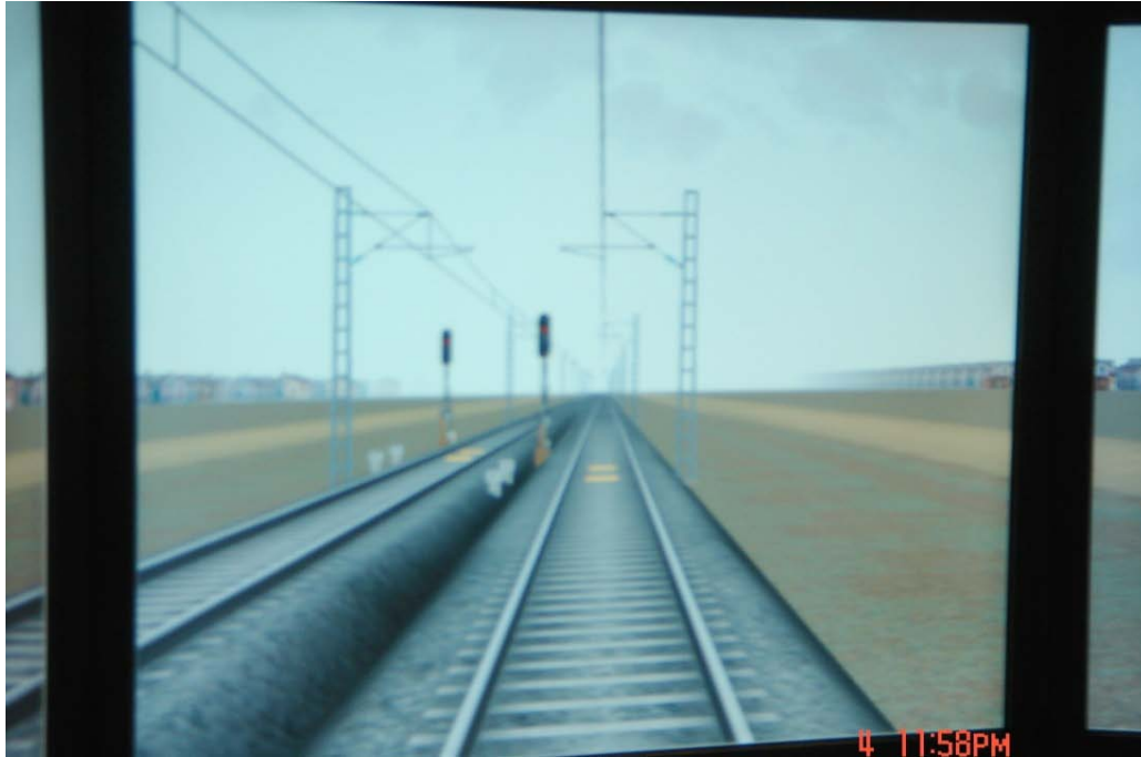
照11. Westinghouse ETCS Level 2 線路模擬測試
