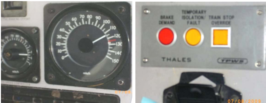
圖64&65. 車上MMI速度表&TPWS車載設備實體圖
