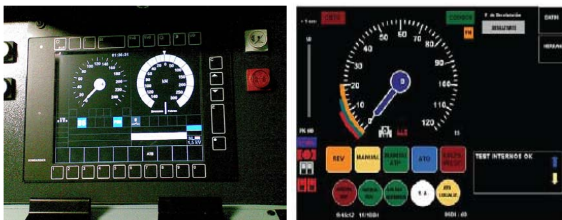
圖79&80. ERTMS Level 3車載MMI&車上號誌
