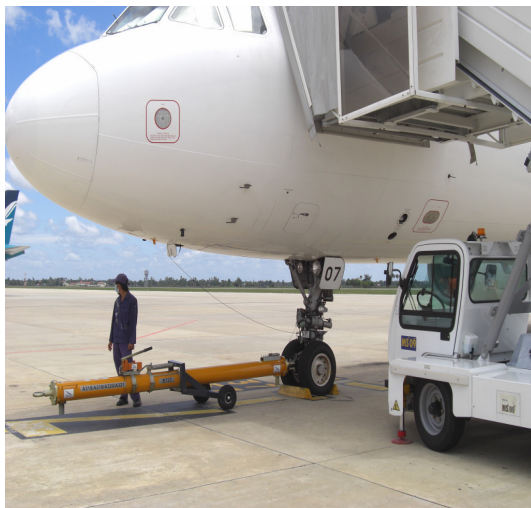
圖2-機邊地勤作業(接上拖桿)
