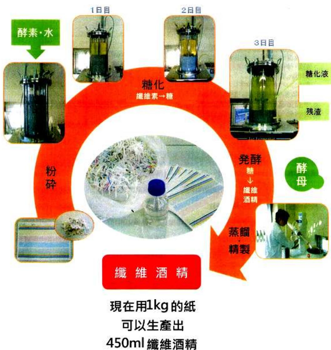
圖2、影印廢紙酵素水解及酒精發酵流程圖
