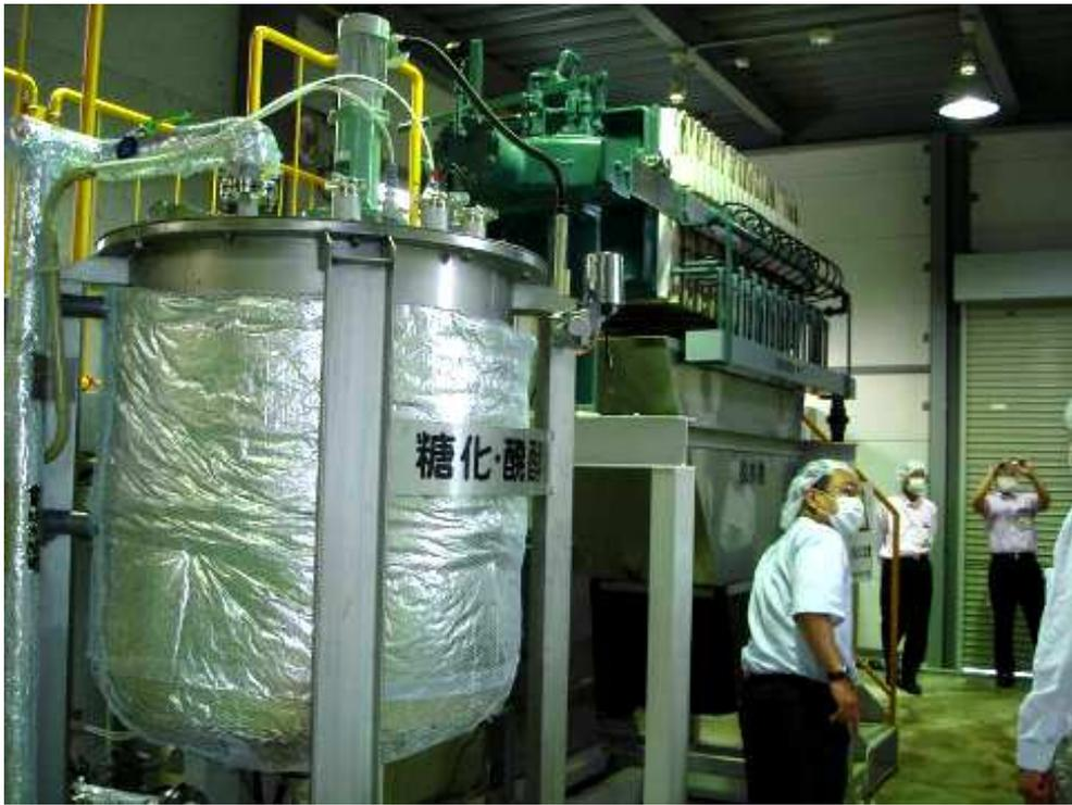
圖4、0.65 噸糖化槽/發酵槽(共用)，後方為固液體分離設備
