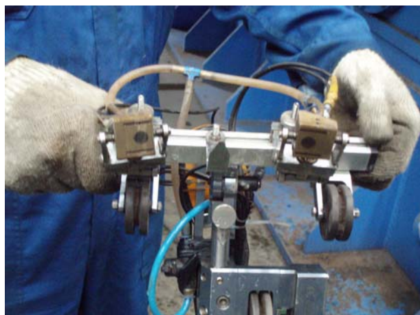
三種厚度之參考規塊與 TOFD 超音波探頭
