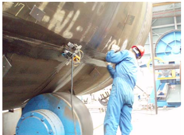
縱向銲道 TOFD 檢測情形
