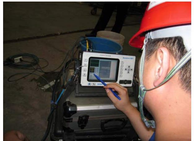
校正作業 三(檢測人員解說檢測道之人工瑕疵)
