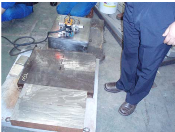
三種厚度之參考規塊與 TOFD 超音波探頭
