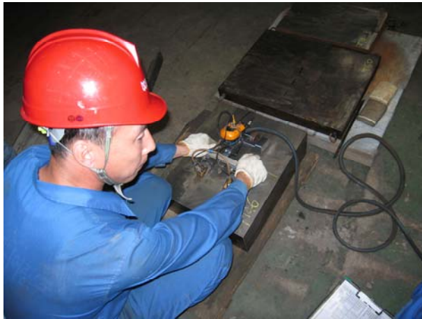
校正作業 二(螢幕上為檢測到參考規塊之人工瑕疵)
