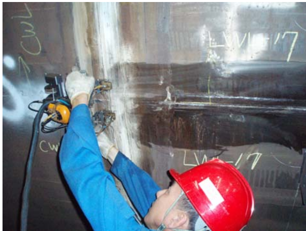
縱向銲道 TOFD 檢測情形
