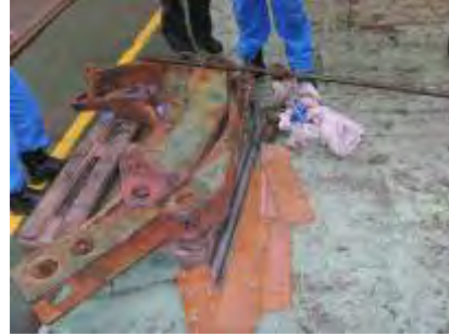
右錨機左邊二號纜機剎車來令片安排船廠更新、打沙
