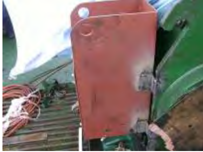
右錨機控制閥箱破損安排船廠更新
