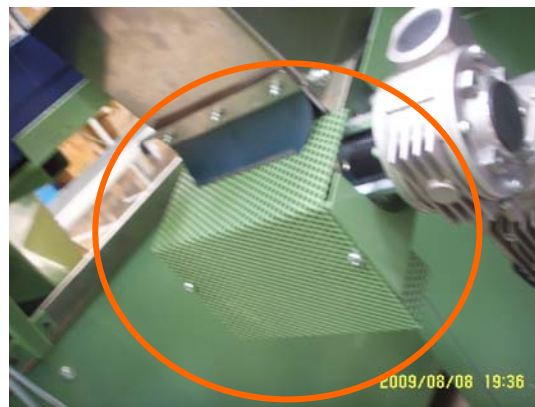
圖十二 轉動機構新增保護蓋
