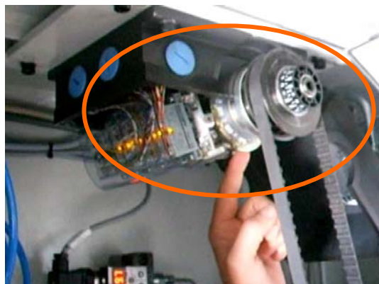
圖二十三 行程凸輪檢知器
