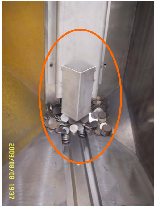
圖十 餅拉昇機口加設導板
