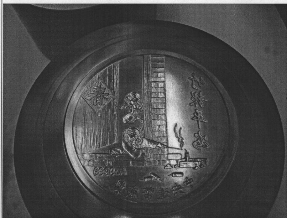
圖說：壓印花模尖頂之情形，壓力為 600 噸及壓製完成之印花模圖案。
