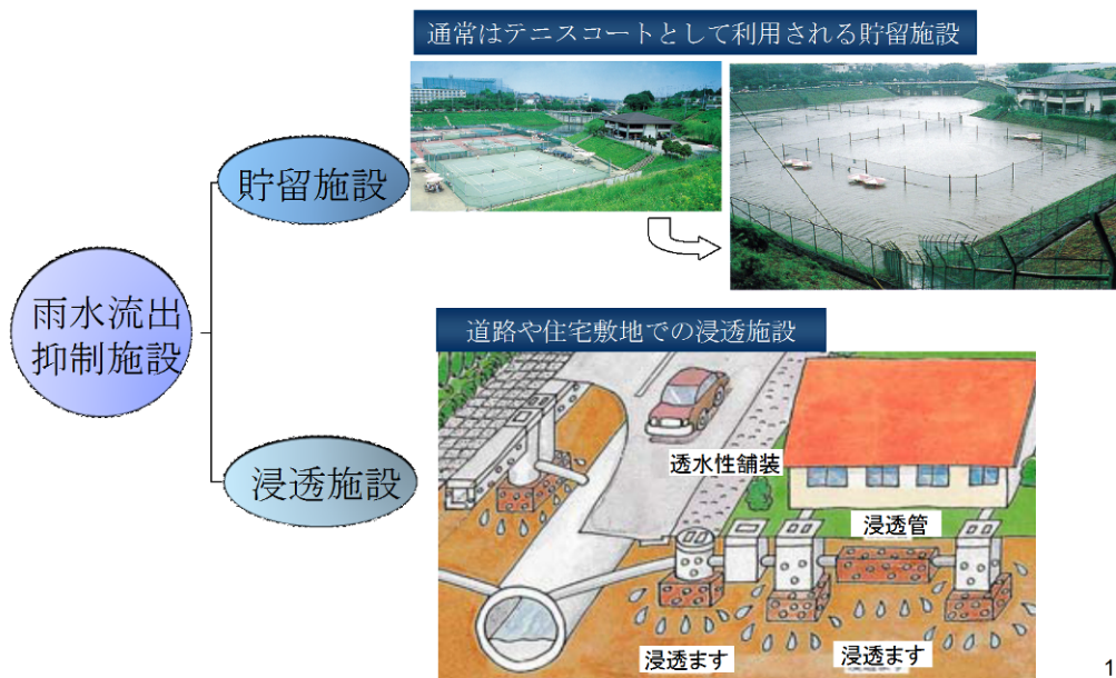
圖 3.13-9 貯留施設與浸透施設
