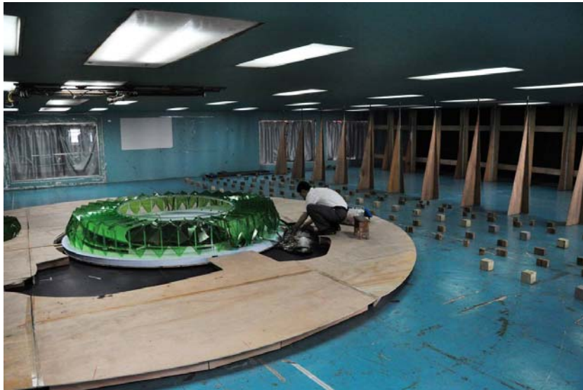
圖 24 TJ-3 風洞及試體安裝
