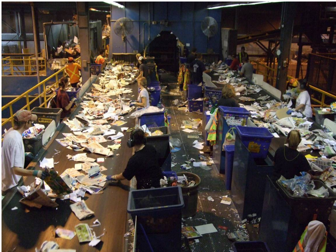
圖 12、尼加拉瓜區資源回收物分類中心紙類分選作業
