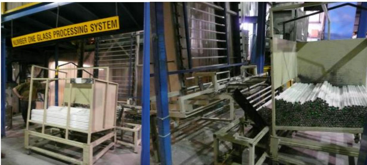
圖 18、Aevitas 公司直管廢照明光源處理－進料系統
