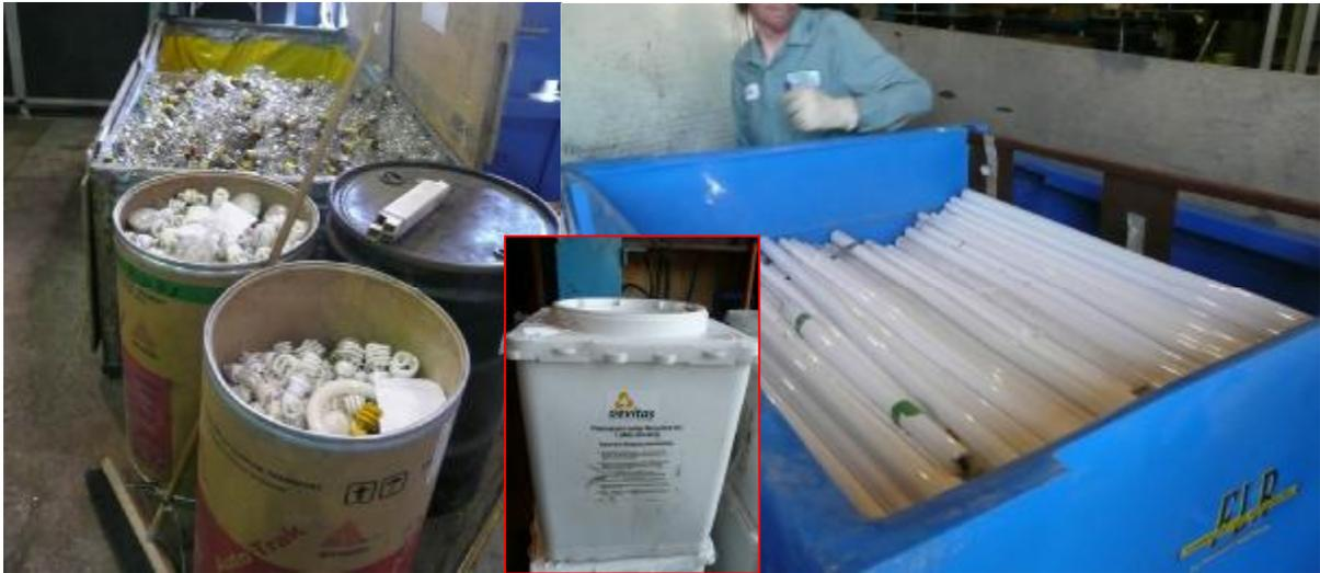
圖 17、廢照明光源貯存設備及回收情形
