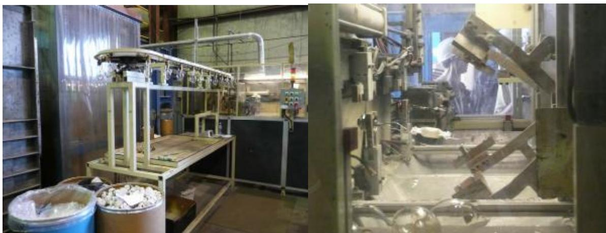
圖 19、高強度照明燈管(HID 燈)處理設備—進料系統(左)及破碎系統(右)
