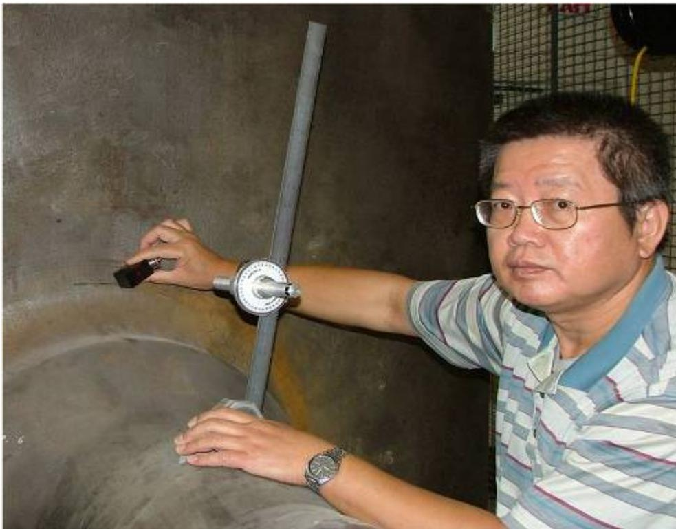
圖3.2 A、架設徑向量規與雷射偏斜角儀於檢測管嘴外徑上。
