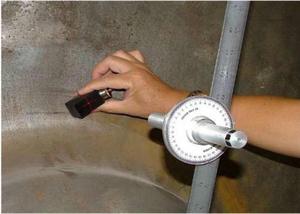
圖3.2 B、架設徑向量規與雷射偏斜角儀於檢測管嘴外徑上\_偏斜角。
