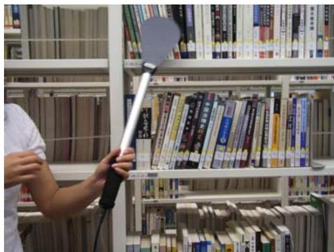
盤點設備結合定位設備
