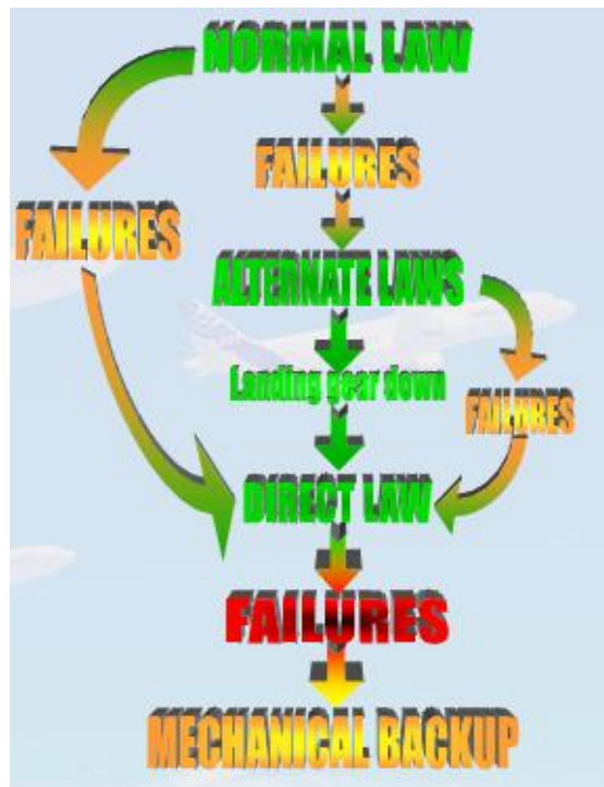
圖 3.4-19 AIRBUS 四層飛航控制率轉換關係
