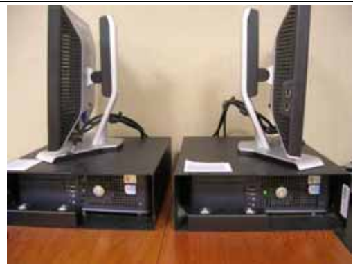
圖 9-8. 公共空間查詢用電腦使用特殊鐵盒包覆電腦主機確保設備安全。
