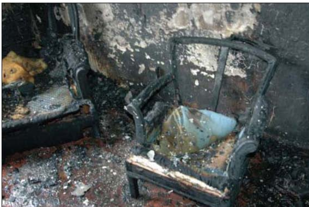
圖 23 二樓靠門口之單人沙發受燒情形較輕微
