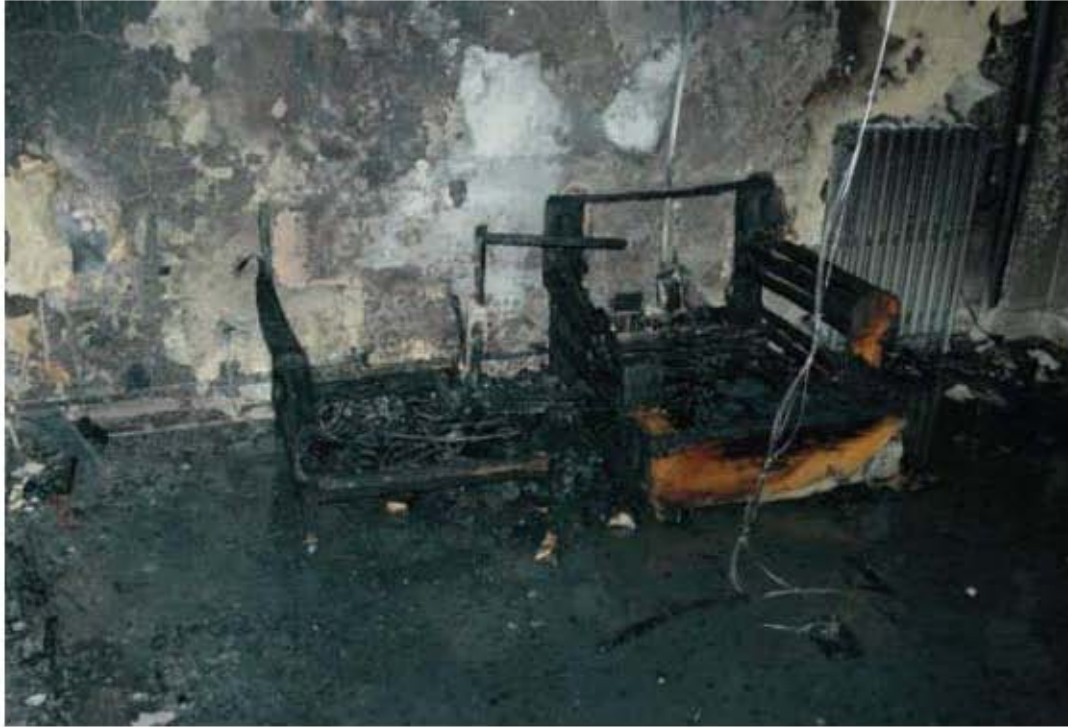
圖 21 一樓單人沙發以靠西側的單人沙發受燒較嚴重
