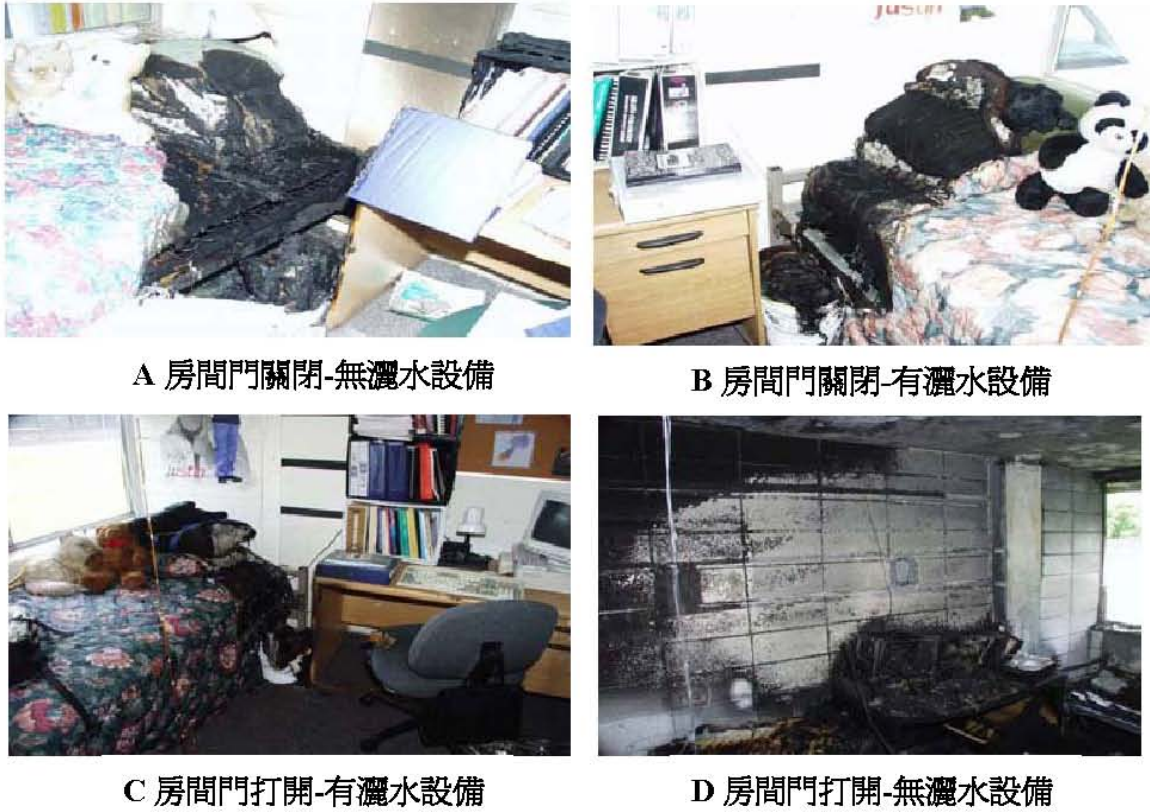
圖 11 實驗 A、B、C 及 D 火災模擬燃燒後燒損情形比較
