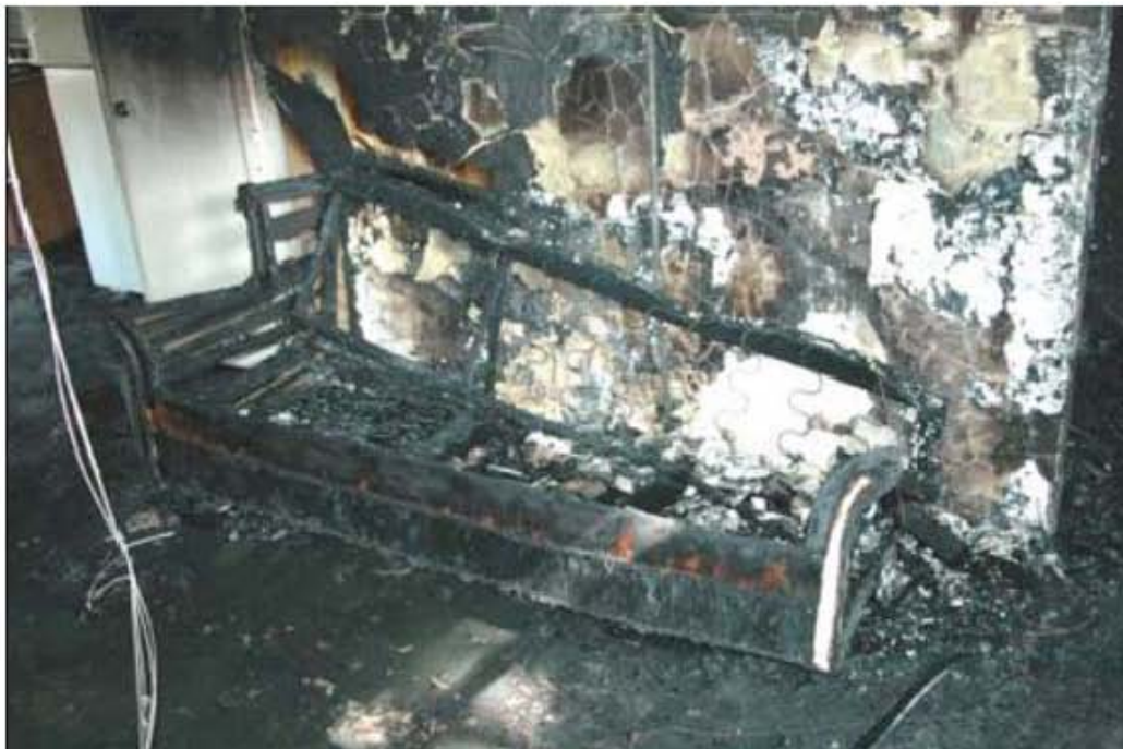
圖 20 一樓長沙發以靠西側受燒較嚴重
