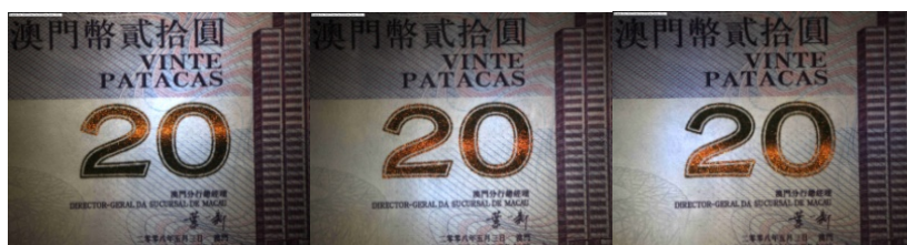
圖 1、Spark 油墨之 rolling-bar 效果，前後移動可看見上下移動之金光 (2008 澳門發行奧林匹克運動會紀念鈔)。
